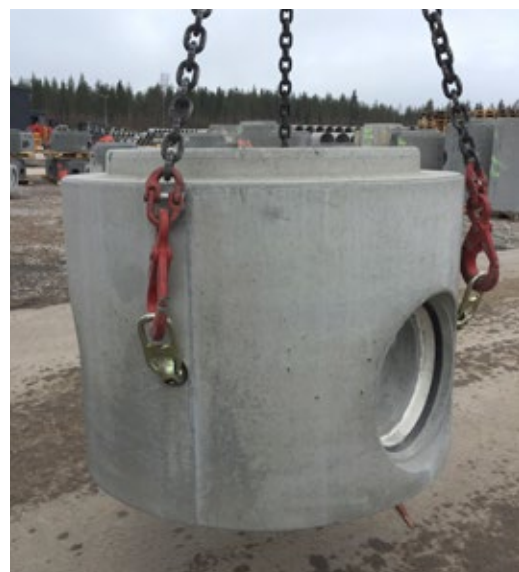
Kuva 4.15. Valun yhteydessä asennettuja kiinteitä nostoelimiä käytetään kooltaan Ø 600....1500 mm monoliittisten kaivoelementtien asentamiseen.
