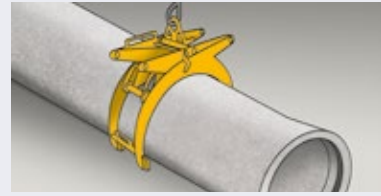
Pienten putkien nostamiseen ja asentamiseen käytetään asennussaksia.
