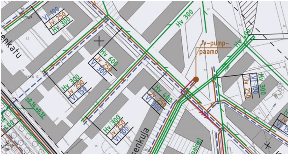
Kuva 5.3. Esimerkki vesihuoltoverkoston yleissuunnitelmasta.
